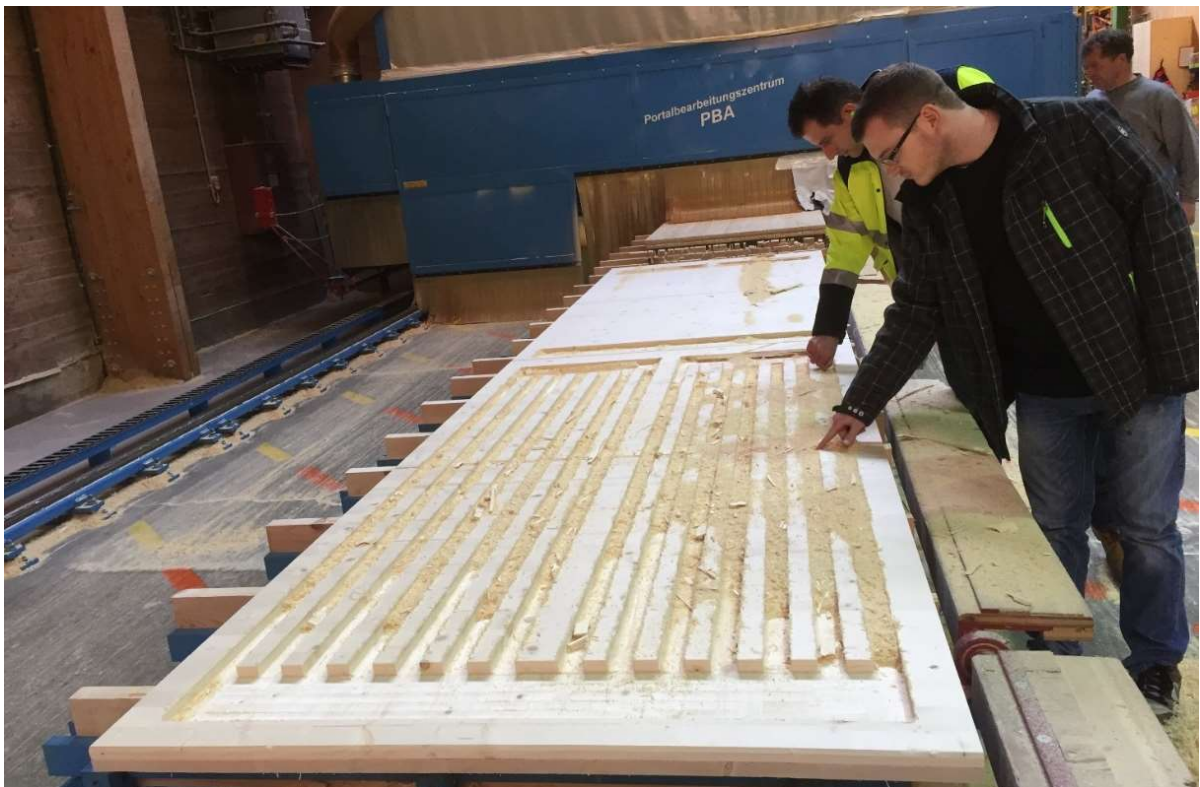
Abbildung 143: Das Fräsen der Kanäle in Schicht zwei hat auch quer zur Faserrichtung dort problemlos funktioniert wo die Lamellen schmalseitenverleimt sind. Als problematisch hat sich der nicht schmalseitenverleimte Stoß zwischen den Massivholzplatten herausgestellt. Siehe Abbildung 145.
