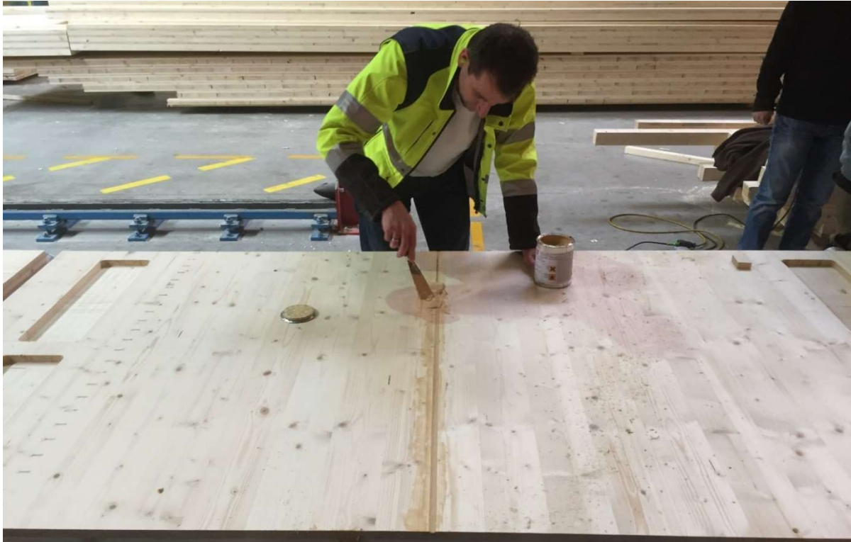
Abbildung 147: Um Undichtigkeiten durch die V-Nut im zweiten Halbelement zu vermeiden wird diese versiegelt.
