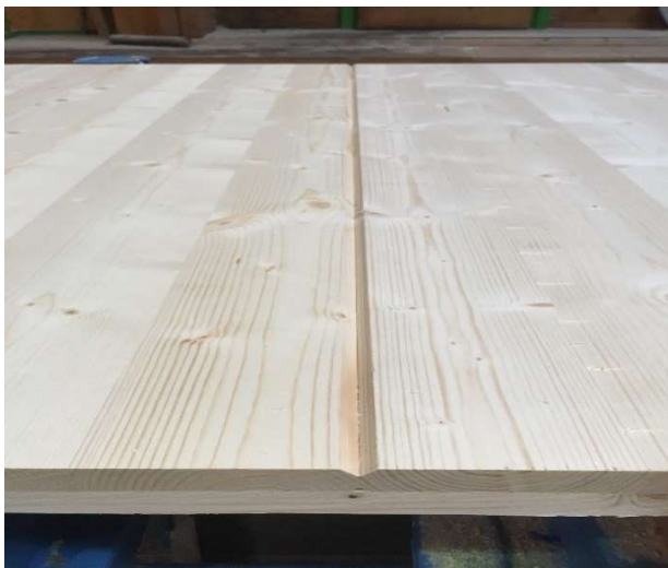
Abbildung 145: Die querliegende Schicht zwei wurde aus schmalseitenverleimten Massivholzplatten hergestellt. Der Stoß dieser Platten besteht aus der in der linken Abbildung gezeigten V-Nut. Die Folge waren Abscherungen, welche beim Fräsen der Kanäle in Schicht zwei in Höhe der V-Nut aufgetreten sind.
