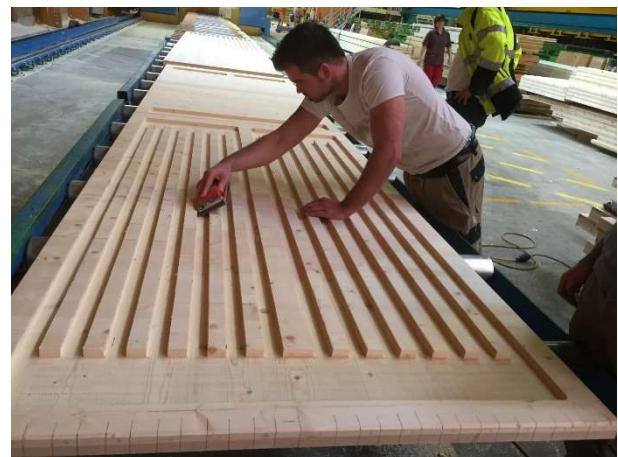
Abbildung 146: Die Abscherungen in Schicht zwei wurden zunächst auf ein definiertes Maß ausgefräst und dann durch das Einkleben von Füllstücken versiegelt. Vor dem Verkleben wurden diese plangeschliffen.
