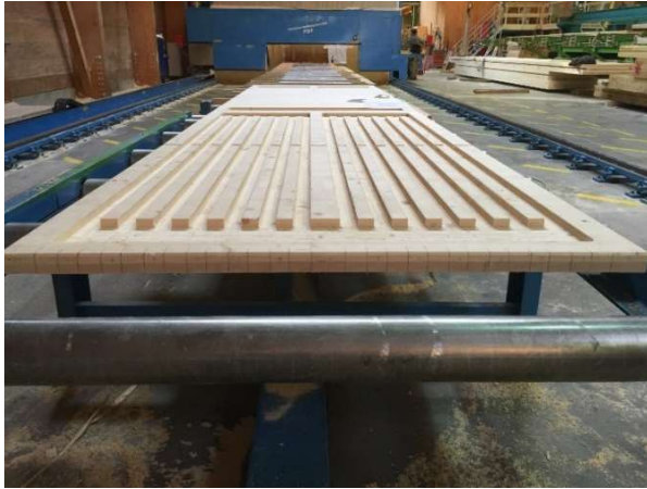
Abbildung 144: Die Maßhaltigkeit der Abbundanlage liegt im Bereich < 1/10 mm. Stichprobenartig konnte diese Toleranz bestätigt werden. Zur späteren Positionierung der Messsensoren wurden die Stege markiert.
