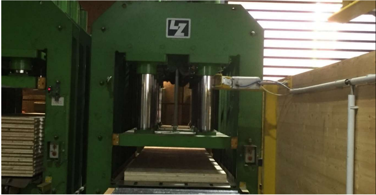
Abbildung 149: Verpressen und Aushärten der Halbelemente im hydraulischen Pressbett.
