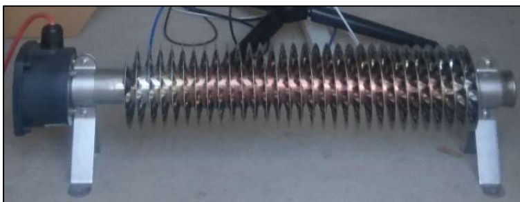
Abbildung 8: Installierter elektrischer Rippenrohrheizkörper
