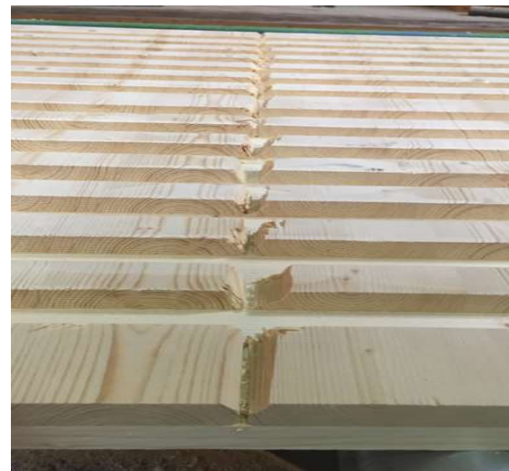
Abbildung 145: Die querliegende Schicht zwei wurde aus schmalseitenverleimten Massivholzplatten hergestellt. Der Stoß dieser Platten besteht aus der in der linken Abbildung gezeigten V-Nut. Die Folge waren Abscherungen, welche beim Fräsen der Kanäle in Schicht zwei in Höhe der V-Nut aufgetreten sind.
