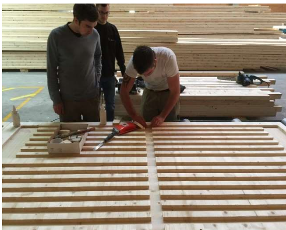
Abbildung 146: Die Abscherungen in Schicht zwei wurden zunächst auf ein definiertes Maß ausgefräst und dann durch das Einkleben von Füllstücken versiegelt. Vor dem Verkleben wurden diese plangeschliffen.
