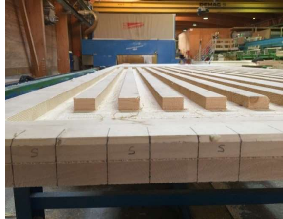
Abbildung 144: Die Maßhaltigkeit der Abbundanlage liegt im Bereich < 1/10 mm. Stichprobenartig konnte diese Toleranz bestätigt werden. Zur späteren Positionierung der Messsensoren wurden die Stege markiert.
