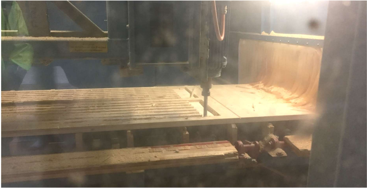
Abbildung 142: Der Abbund der Halbelemente erfolgt mit einem 30mm Nutfräser. Bei quer zur Faserrichtung verlaufenden Fräskanälen ist auf die Schmalseitenverleimung zu achten um eine Sperrwirkung gegen Abscherungen zu bewirken.
