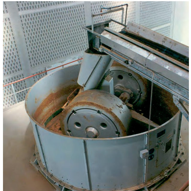
Bild 7.64. Kollergang mit mittlerer Aufgabe
