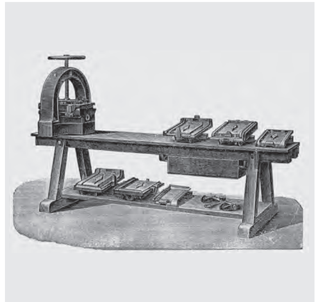
Bild 8.123. Gipspresse zum Abgießen der Arbeitsformen von der Mutterform, um 1900
