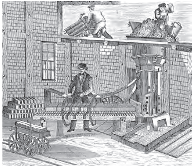
Bild 12.8. Dieses Bild der ersten stehenden Schneckenpresse mit Dampftrieb erschien am 20.11.1858 in der „Leipziger Illustrierten Zeitung“
