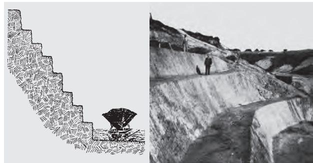
Bild 6.14. Strossen- oder Treppenabbau
