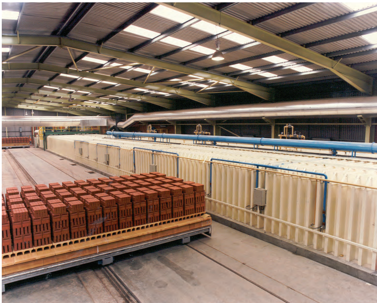
10.170. Tunnelofen mit Stahlmantel, 1985, Ceric S.A., Paris
