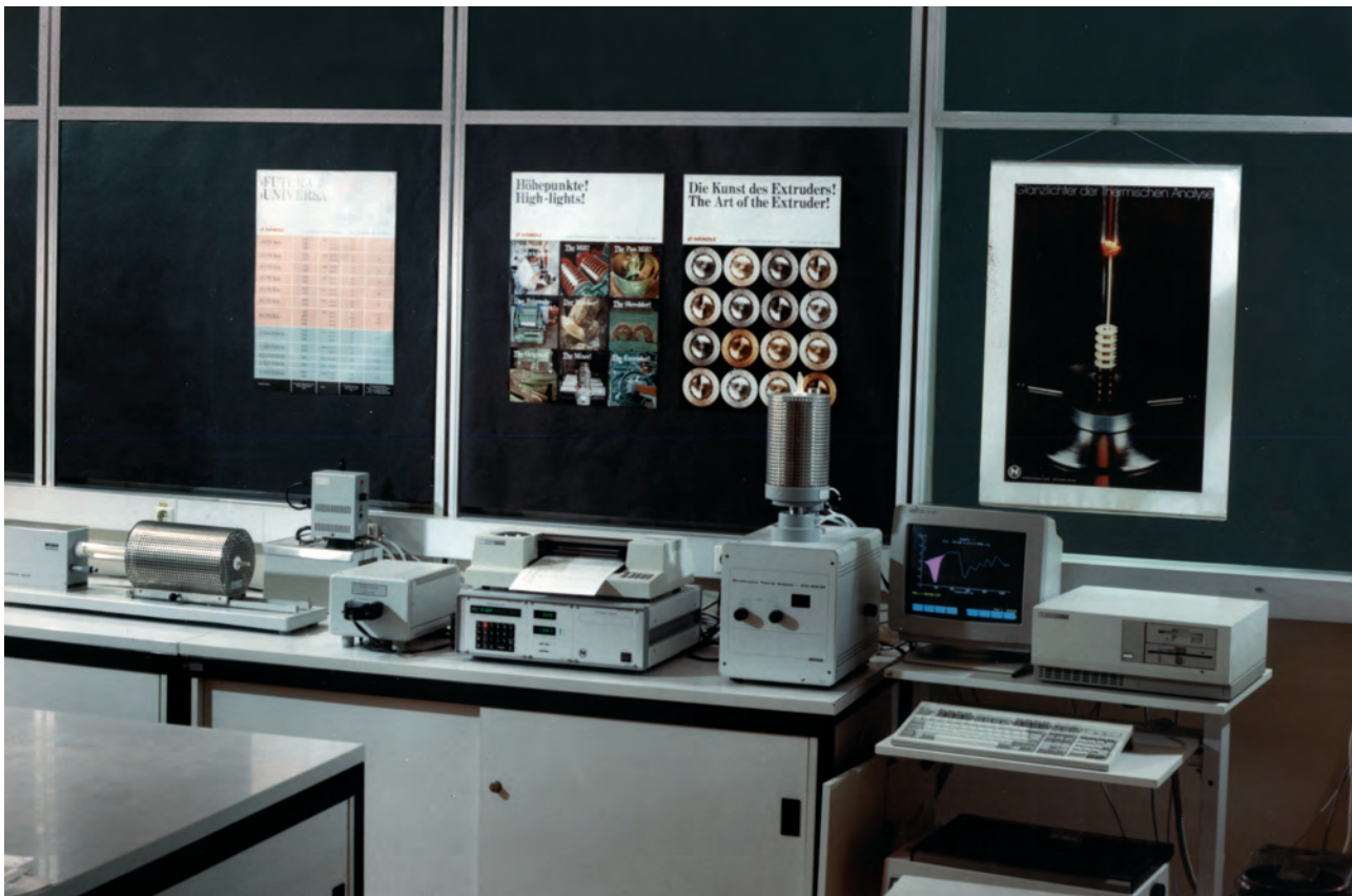
Bild 5.42b. Thermoanalytische Abteilung mit Analysegeräten für Simultane Thermoanalyse (STA) und Dilatometrie (DIL) mit Datenerfassung und -auswertung über Rechner
