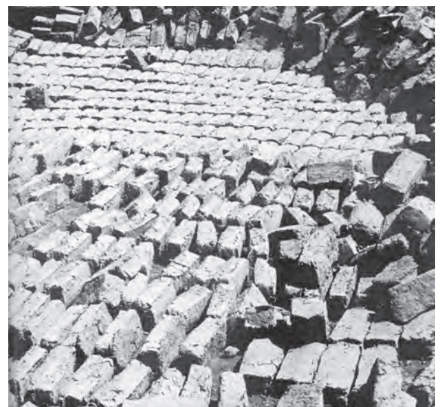
Bild 1.9. „Urziegel“ – an der Sonne trocknende Luftziegel, wie sie seit dem 8. Jt. v. Chr. und in Entwicklungsländern noch heute hergestellt werden
