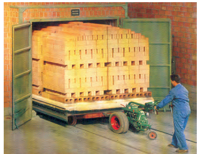
Bild 11.73. Ofenwagenbugsierer zum Verschieben der Tunnelofenwagen, um 1955
