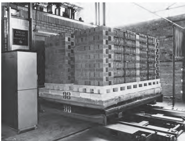
Bild 11.75. Ofenwagen-Fahrbühne mit Schubvorrichtung
