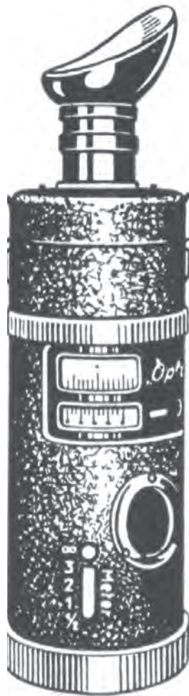
Bild 10.13. Optischer Pyrometer zur Messung der Brenntemperatur durch die Schürflöcher
