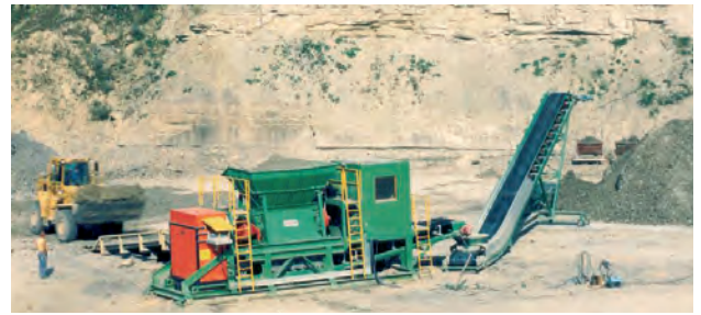
Bild 7.45. Mobiler Hydraulikbrecher, installiert in einer Tongrube, 1985
