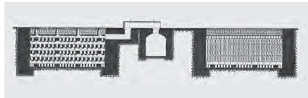
Bild 10.150. Querschnitt des Erdringofens
