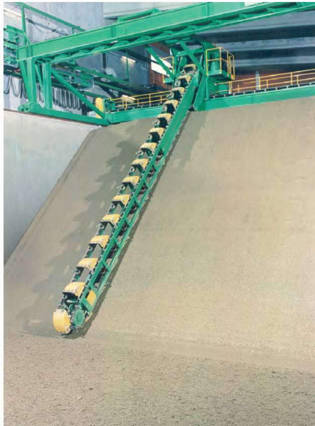
Bild 7.126. Blick auf die Baggerfahrbühne mit Querbagger mit Hydraulikhubwerk aus einem Sumpfbecken, 8 m tief und 20 m breit, 1992
