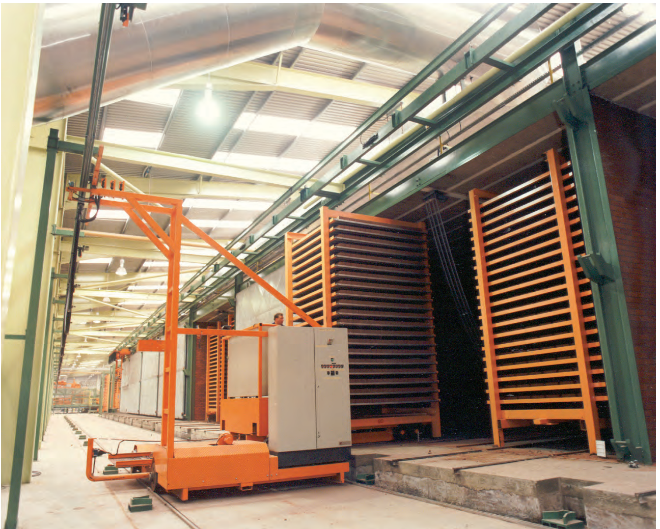
Bild 11.56. Einschleiben eines Kastenwagens in die Trockenkammer durch eine automatische Fahrbühne
