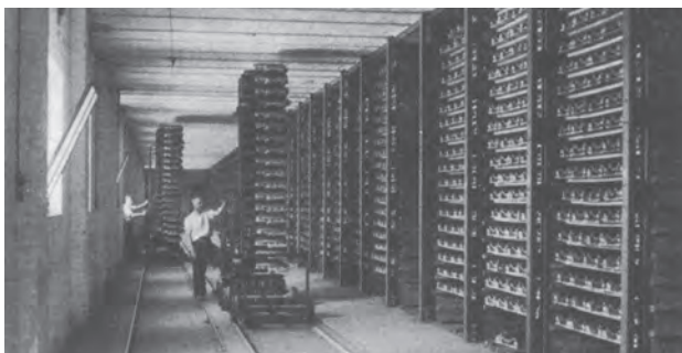
Bild 11.44. Zweigleisiger Trocknergang mit Handschiebebühnen
