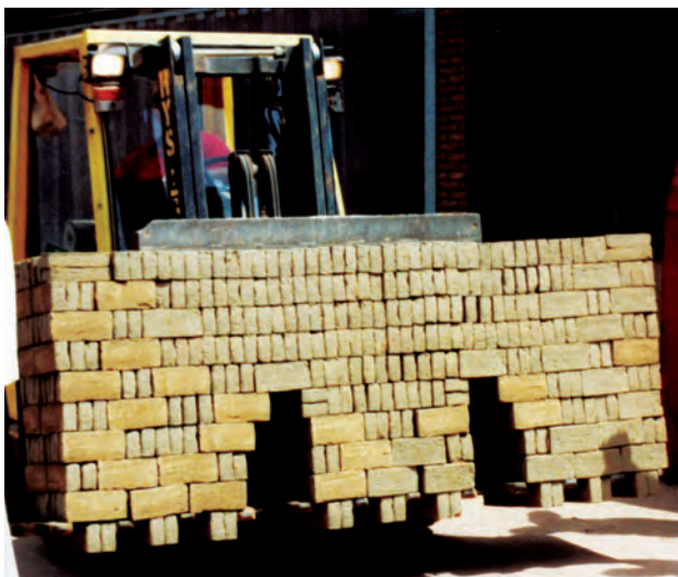
Bild 10.146. Die Ziegelei Randwijk in Heteren/Niederlande betreibt noch einen kohlebefeueten Flammofen zur Herstellung von Handstrich-Verblendziegeln. Blick in die Ofenkammern, Hubstaplerbetrieb und Lagerplatz, 2001
