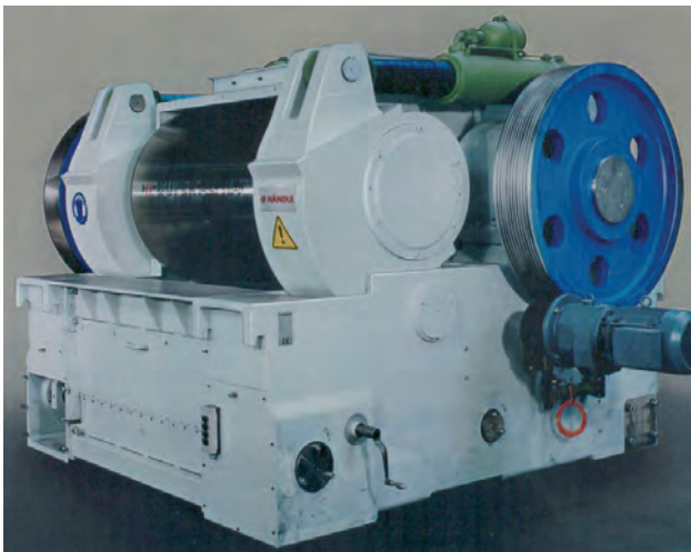
Bild 7.39c. Unten rechts im Bild: Reibradantrieb an der Riemenscheibe mit dem die Walze zum Walzendrehen angetrieben wird, um die optimalen Drehzahlen von etwa 30/min zu erhalten, anstelle der bei der Walzarbeit üblichen Drehzahlen um 300/min
