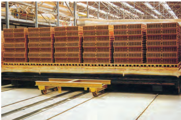
Bild 10.27b. Ofenwagenbesatz mit Langlochziegeln
