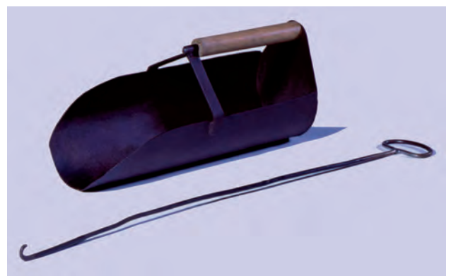
Bild 10.103a. Brennerschaufel zum Aufgeben der Kohle von Hand und Haken zum Hochheben der Schüttlochdeckel (Fotoarchiv Westfälisches Industriemuseum)
