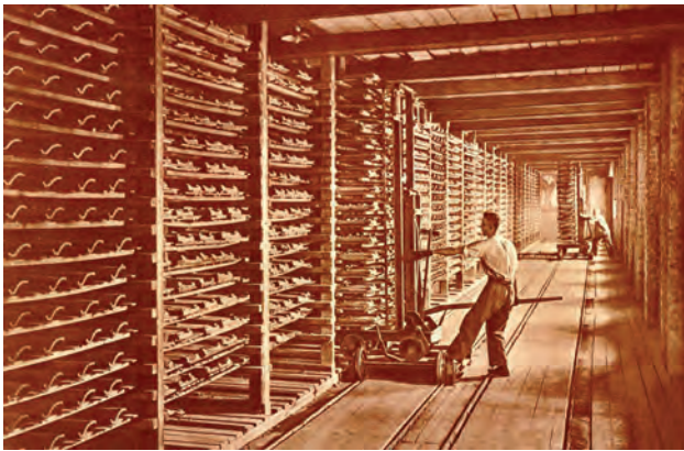
Bild 9.35. Für Absetzwagenbetrieb eingerichteter Großraumtrockner, 1925
