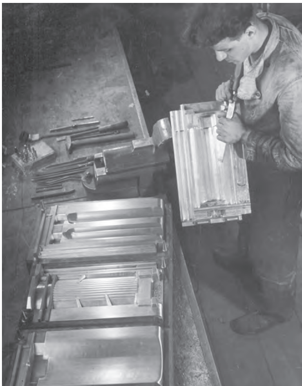
Bild 8.122. Bearbeitung der Mutterformen beim Hersteller, 1935
