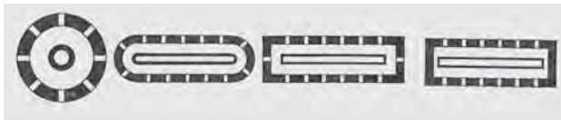
Bild 10.128. Ringofen-Grundrißformen, von links nach rechts: rund, oblong, mit geraden Kopfkammern, mit Verbindungskanal für die Heizgase
