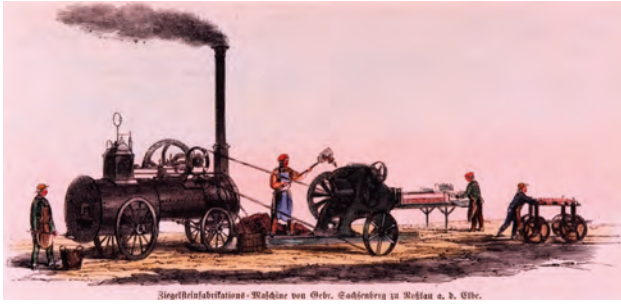
Bild 12.16. Lokomotive zum Antrieb einer Walzenpresse von Sachsenberg (Archiv des Westfälischen Industriemuseums)
