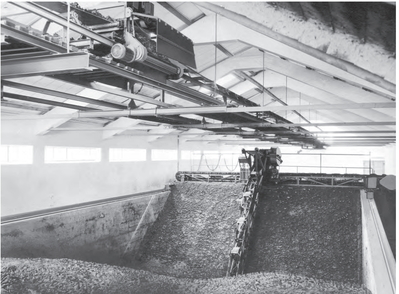
Bild 7.124. Quersumpfanlage: Tonzuführung über Stahlbandtransporteur und Abwurfmaschine mit Schleuderwalzen, 1960
