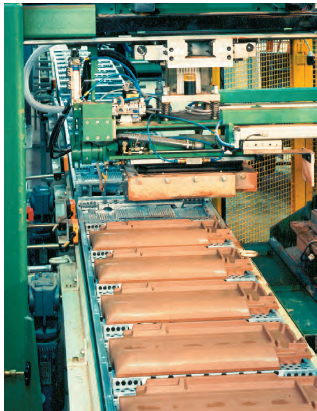
Bild 8.104b. Entgraten, Abnehmen und Ablegen der Formlinge von den Unterformen durch Saugkopf mit Messerkasten
