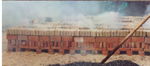
Bild 10.37. Demonstration eines Meilerbrands „Belgische Art“ anlässlich der 8. Arbeitstagung Ziegeleigeschichte/Ziegeleimuseen 2001 im Ziegeleimuseum „De Panoven“ in Zevenaar/Niederlande Panoven
