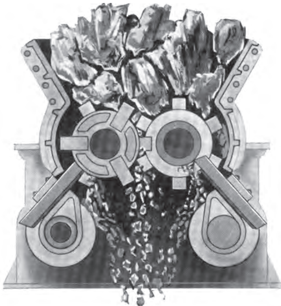
Bild 7.43. Schnitt durch einen Walzenbrecher bei der Arbeit
