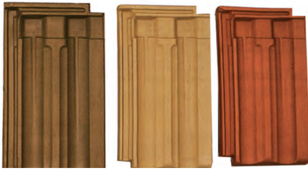
Bild 5.36. Längenänderung durch Trocken- und Brennschwindung. Links: Formling, Mitte: getrockneter Rohling, rechts: gebrannter Ziegel
