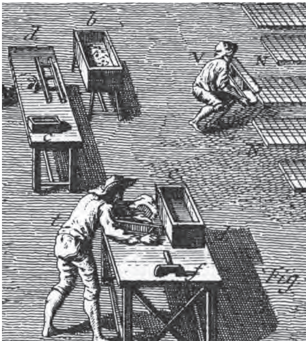
Bild 8.5. Streichtisch und Ablegen der Formlinge auf dem Plan in einer Feldziegelei des 18. Jahrhunderts
