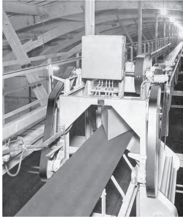
Bild 11.15. Stahlband mit beidseitigem Materialabwurf mittels Pflugabstreifer
