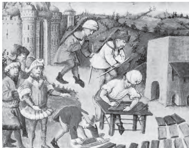
Bild 4.19. Mittelalterliche Flachziegelherstellung vor der Stadtmauer, eine Buchmalerei aus der Zeit um 1460. Dargestellt wird der Streichtisch, das Ablegen der Formlinge auf dem Boden zur Trocknung und ganz rechts der oben offene, vierseitig geschlossene „Altdeutsche Ofen“.
