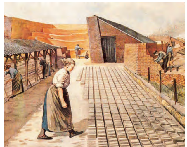
Bild 10.52. Im Hintergrund sichtbar: Holländischer Waalofen mit seitlicher Brennschauer, um 1900
