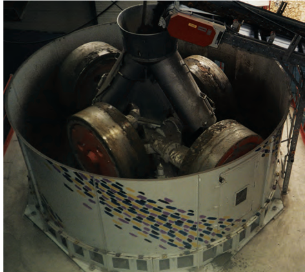
Bild 7.67. Kollergang Quadro im Einsatz in einem französischen Dachziegelwerk, 1998
