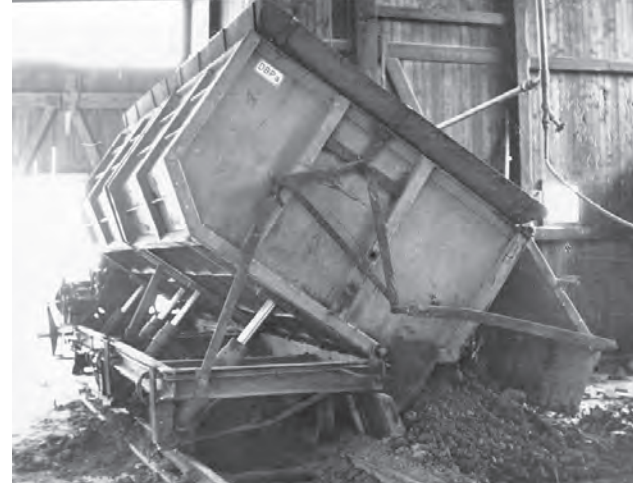
Bild 6.48. Selbstfahrwagen Olfry 1963, im Bild oben mit dem Konstrukteur Günter Menkens, unten beim Entleervorgang
