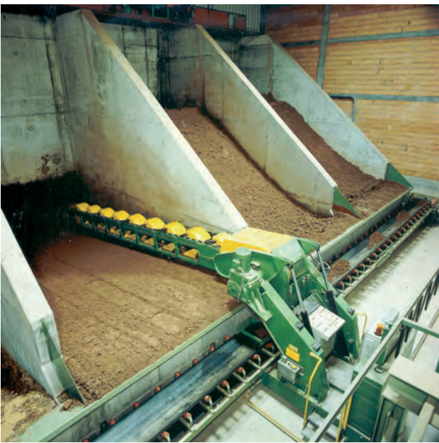
Bild 7.121a. Eimerketten-Längsbagger mit Hydraulikhubwerk für die Eimerleiter mit Knickpunkt und Ablenkuras, um 1975
