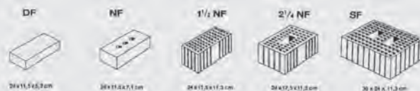
Bild 2.21. DIN-Formatziegel: Mit der neuen DIN 105, Ausgabe Januar 1952, wurde das alte Reichsformat durch das neue deutsche DIN-Format abgelöst. Zunächst waren vier Vorzugsformate vorgesehen: das Dünnformat DF, das Normalformat NF, das 1 1/2 Normalformat 2 DF, das 2 1/4 Normalformat 3 DF und in Süddeutschland noch das Sonderformat SF.
