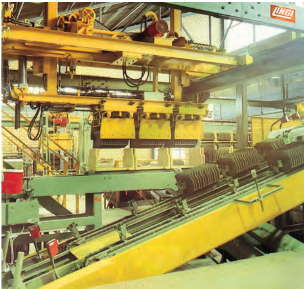
Bild 11.66. Automatisches Setzen der Dachziegel in die Kassetten
