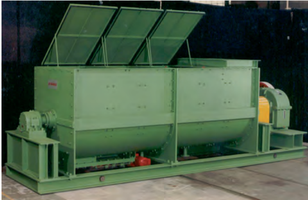
Bild 7.86. Liegender Zentraltonschneider mit aufmontiertem Brechwalzwerk, um 1910
