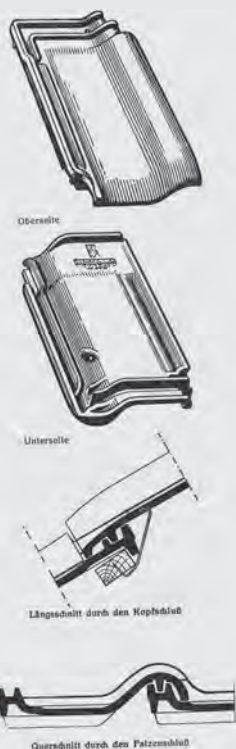
Bild 2.48. Mit der Flachdachpfanne Z15a von Ludowici kam 1930 eine völlig neue Dachziegelgeneration auf den Markt, die bis 1954 den Stand der Verfalzungstechnik darstellte und erstmals mit einer Ringverfalzung eine regensichere Eindeckung flachgeneigter Dächer bis etwa 15° ermöglichte. Ursächlich für die Entwicklung der Flachdachpfanne waren die Architekturströmungen des Bauhauses Dessau, die das Flachdach propagierten und einen starken Trend zum flachgeneigten Dach bewirkten.
