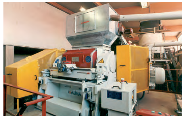
Bild 7.29. Schwingenwalzwerk Händle Alpha I mit angebauter Drehmaschine, Materialeinlauftrichter mit Anschluß an die Entstaubungsanlage
