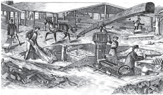
Bild 4.23. Stehende, pferdebetriebene Ziegelmaschine von C. Schlickeysen, die von Hand aus den danebenliegenden Sumpfruben beschickt wird, um 1870
