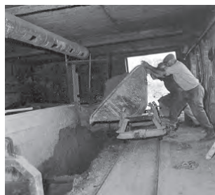
Bild 6.41. Entleeren der Kipploren auf dem Schüttboden in die Kastenbeschicker
