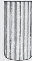
Bild 2.38g. Korbbogenschnitt, stellt einen Mittelweg zwischen Segment- und Rundschnitt dar. Ein traditioneller Schnitt der sich oft bei dem sog. Kirchenbiber findet.
