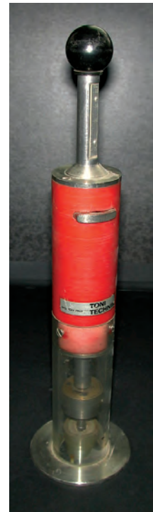
Bild 5.13. Plastimeter oder Eindringprüfer zur Messung der Strangsteife
