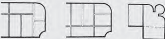
Bild 2.17c. Verbandslösungen mit den Normalprofilziegeln Nr. 4,5,6, und 7
