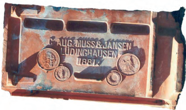
Bild 2.64b. Muldenfalzziegel, Text: „C. Aug. Muß & Jansen, Lüdinghausen, 1881“, mit 4 Plaketten von auf Ausstellungen erzielten Prämierungen. (Bei Ziegel (a) sind diese Auszeichnungen durch die beiden Ortsangaben mit der Jahreszahl ausgewiesen.)
