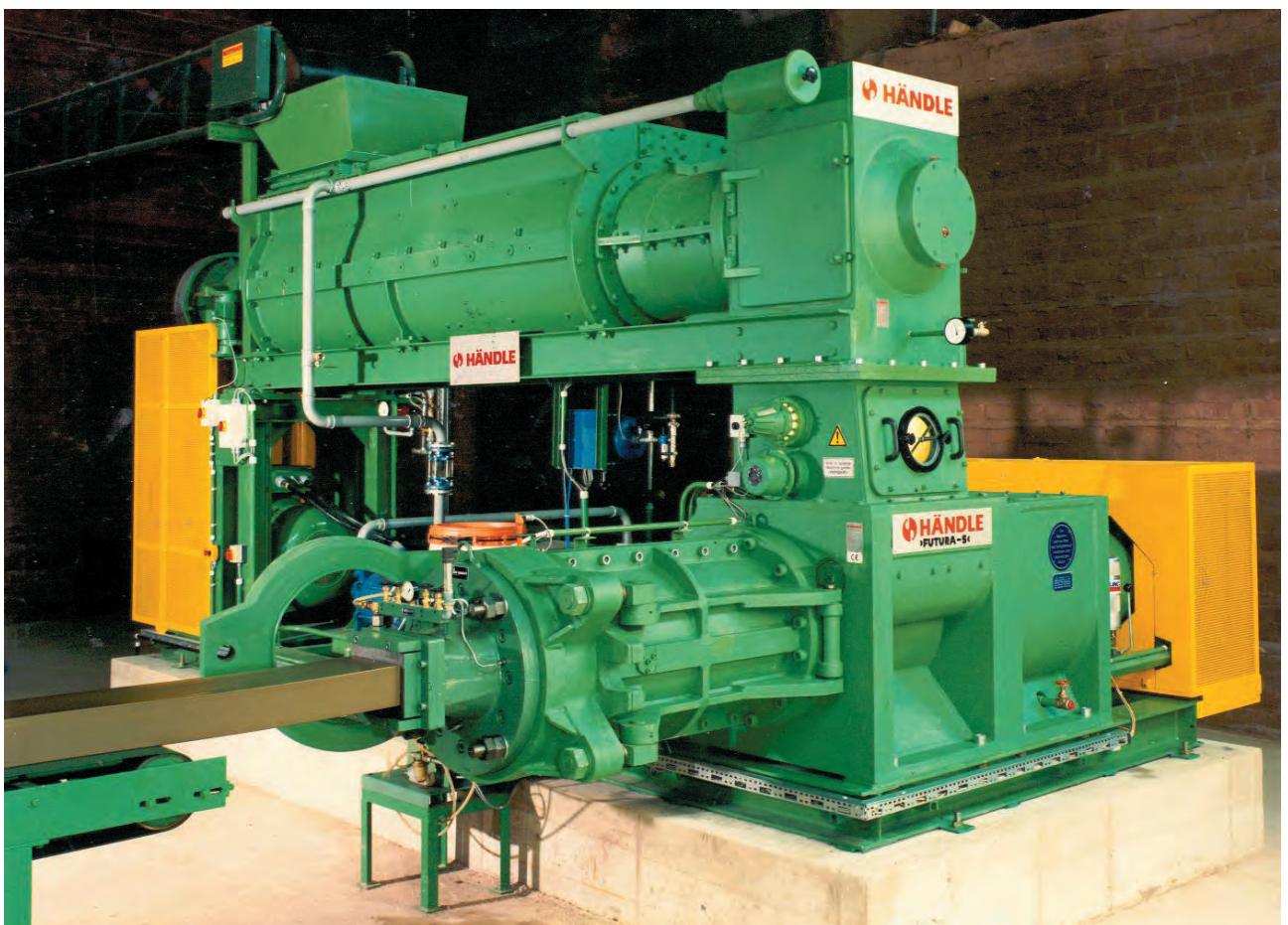
Bild 8.78. Vakuumaggregat von Händle mit Einwellenmischer und Steifextruder, Preßkopf mit Beölung und Preßkopfschwenkvorrichtung, 1992
