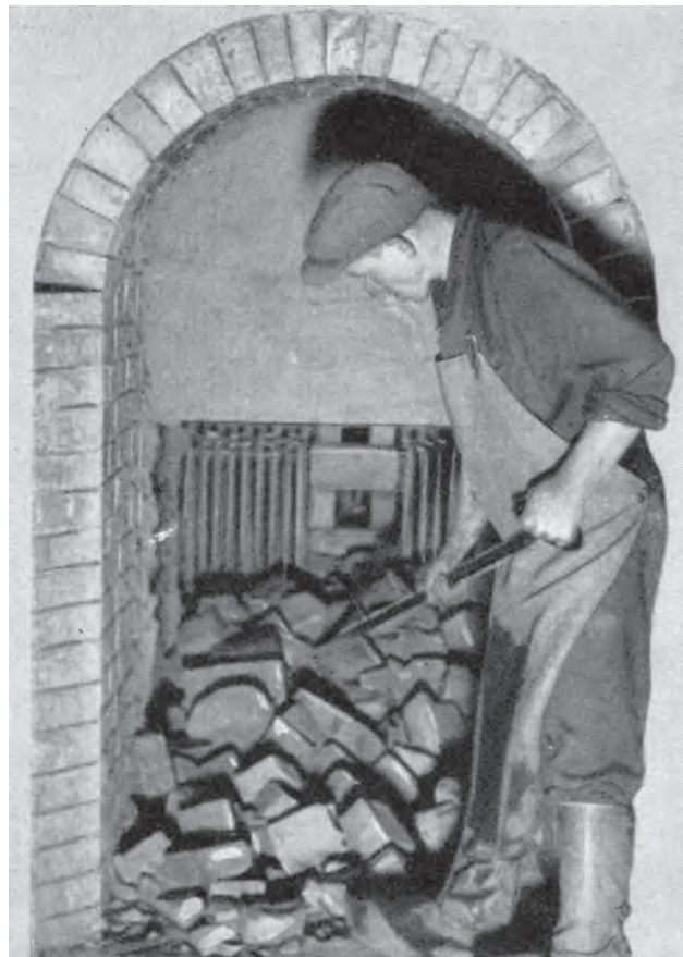
Bild 10.112. Öffnen einer abgebrannten Ringofenkammer durch Einstoßen der Sandtüre
