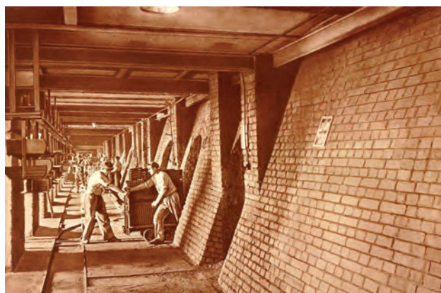
Bild 10.113. Gang vor dem Ringofen mit manuellem Setz- und Ausfahrbetrieb, um 1925
