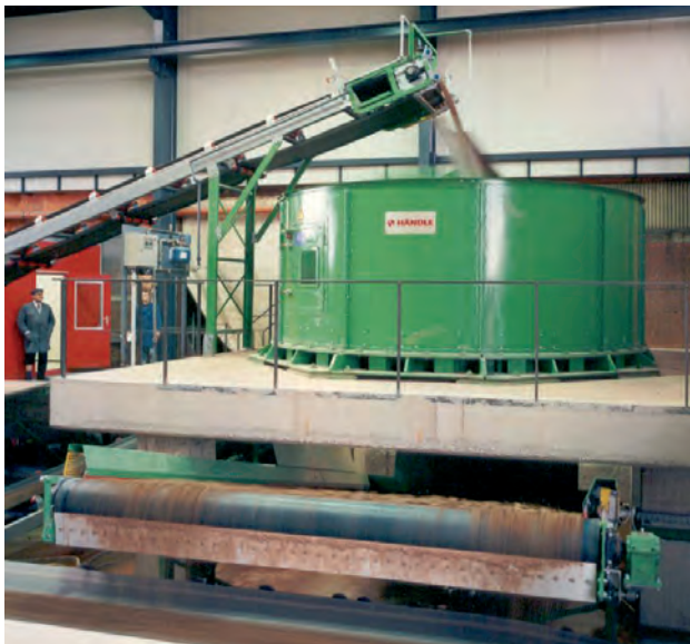
Bild 7.69. Kollergang mit mittlerer Materialaufgabe und 4,5 m breitem Materialabzugsband
