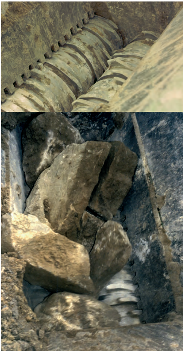
Bild 7.44. Blick in einen Walzenbrecher mit Zahnscheiben bei der Zerkleinerung von grobscholligem Ton
