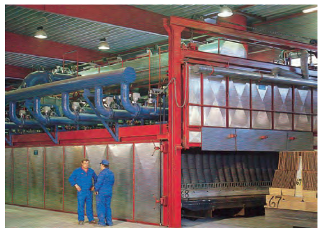
Bild 10.69. Herdwagenofen zum Blaudämpfen von Dachziegeln, um 1990, Fa. Instalat BV, NL-Lent
