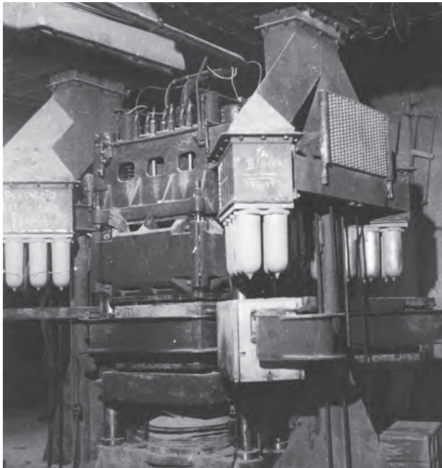
Bild 8.96a. Locatelli-Trockenpresse mit durch Öldruck aufweitbaren Formkernen (Gummipunzen), die das Material in horizontaler Richtung verfestigten, 1953
