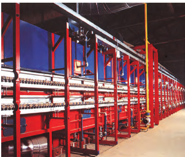
Bild 10.189. Doppelstagen-Rollenofen von Mori im Ziegelwerk Gumbmann/Niederndorf für eine Leistung von 200 t gebrannter Porotziegel/Tag, 1989
