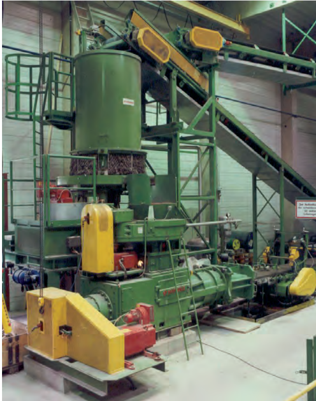
Bild 7.81. Tonraspler zur Beschickung eines Vakuumaggregats
