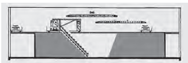
Bild 7.125. Schema einer Quersumpfanlage mit zwei Bandfüllbühnen zur Befüllung, 1985
