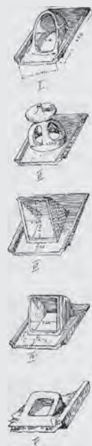
Bild 2.31c. Lichtziegel zum Einlegen einer Glasplatte
