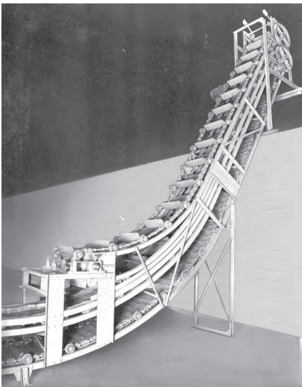
Bild 11.14. Schuppenband-Steilförderer für Steigungen bis 60^\circ von Händle, 1953
