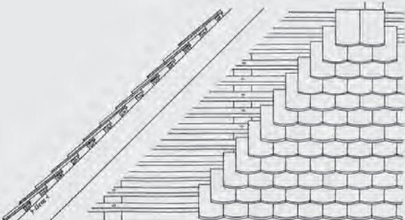
Bild 2.39b. Doppeldach, früher auch gemeines oder ordinäres Doppeldach genannt
