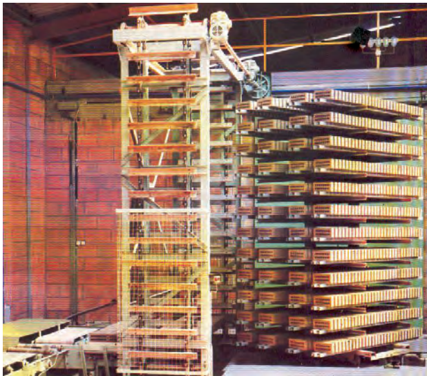
Bild 9.50. Tragarmwagen des Lingl-Durchlaufrockners
