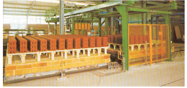
Bild 11.64. Entlademaschine, die mit Spezialgreifern in einem Hub sechs Formlingstürmchen vom Ofenwagen abnimmt und wechselweise auf zwei Gurtförderer absetzt
