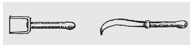
Bild 8.115b. Putzgabel und Putzmesser zum Entgraten der Preßdachziegel
