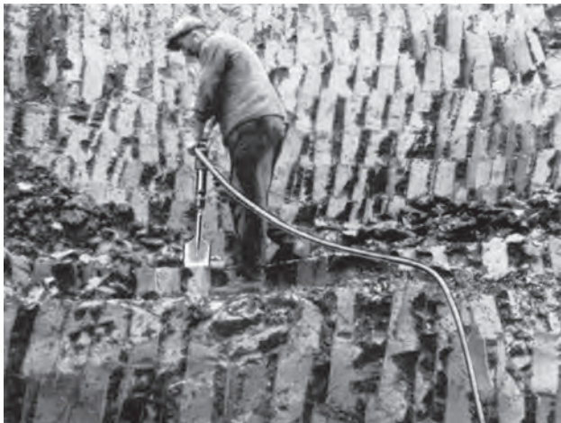
Bild 6.30. Tongewinnung mit dem Preßluftspaten
