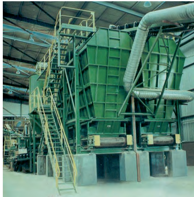
Bild 7.77. Zwei Großraumkastenbeschicker zur Pufferung von aufbereitetem Material, 1990
