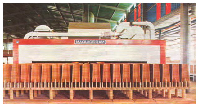
Bild 10.29b. Senkrecht stehend gesetzte Schalenziegel, die mit kurzen Schamottestäben gehalten werden
