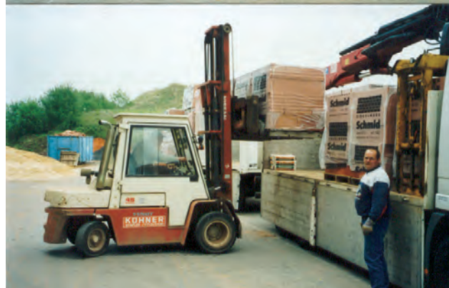
Bild 11.83b-e. Ziegeltransport um 2000: Beladung der LKW mit dem Gabelstapler, Selbstentladung mittels Autokran,
