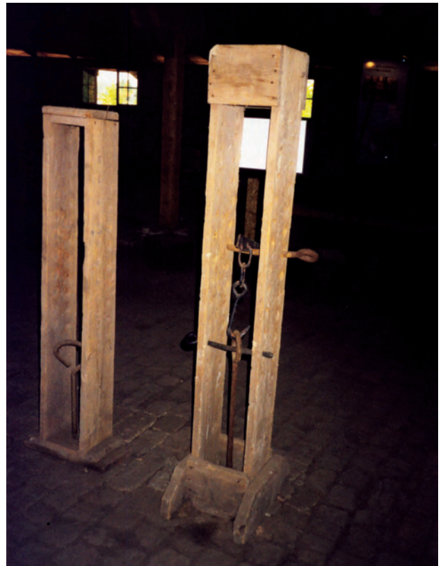
Bild 10.119. Hölzerner Bock zur Höhenfixierung der Glocke
