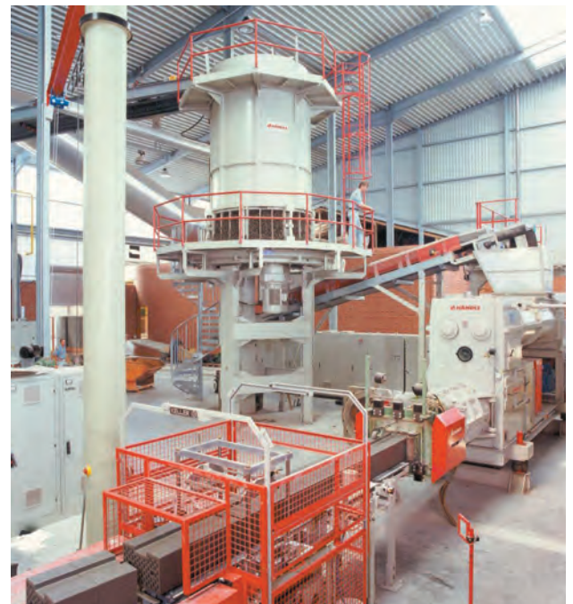
Bild 8.82a. Vakuumaggregat mit vorgeschaltetem Tonrasppler, 1995
