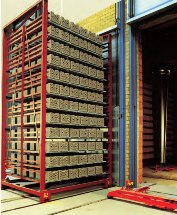
Bild 11.55. Beladener Kastenwagen vor der Trockenkammer
