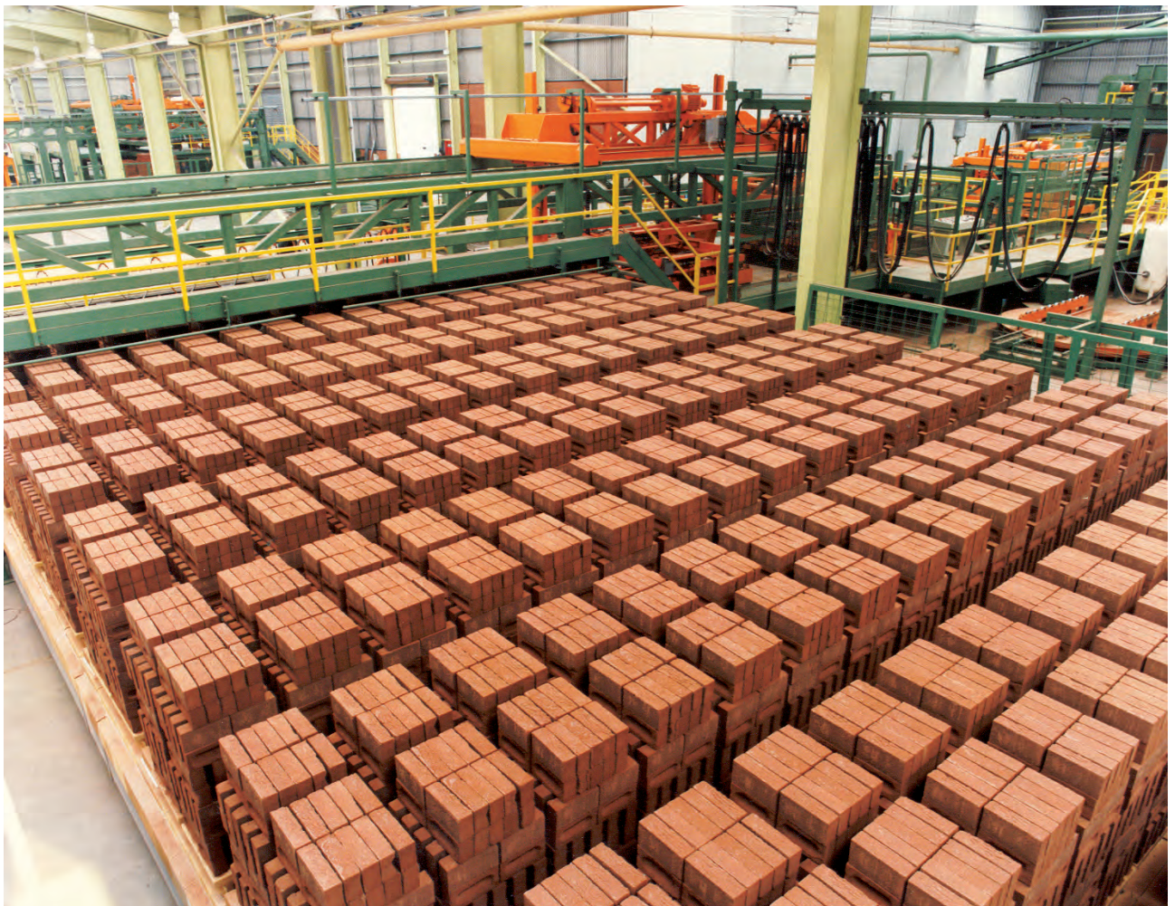
Bild 11.63. Entlademaschine in einem Weichsteinziegelwerk
