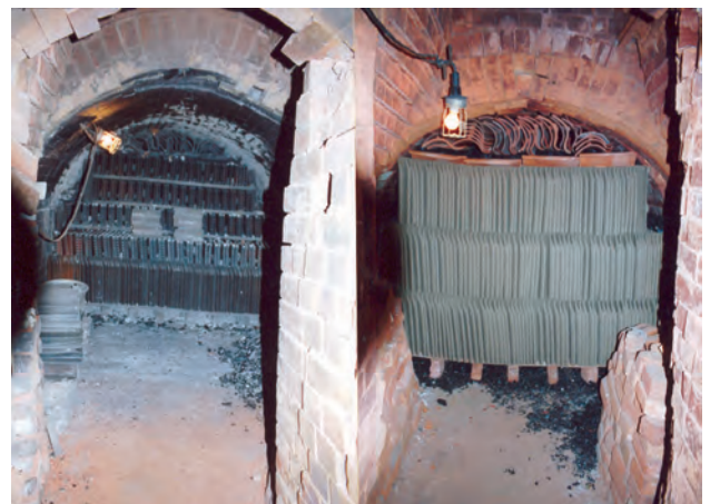
Bild 10.68. Historische Dämpföfen in Funktion bei Firma Alphons Mayer KG in Emmerich, 2001: Blick in eine abgebrannte und eine frisch gesetzte Ofenkammer
