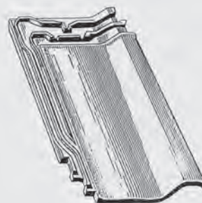
Bild 2.50. Mit dem Flachkremper K21 von Ludwig Franz Ludowici kam 1954 wieder ein gänzlich neuer Typ von Falzziegeln auf den Markt. Es war ein Dachziegelmodell mit einer geschlossenen Ringverfalzung, der sog. Spiralverfalzung, mit der ein extrem dichter Falzen- und Vierziegeldeckverschluss erreicht wird.
