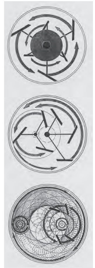
Bild 7.90. Chargenmischer. Oben: Ringtrog-Mischer, Mitte: Planeten-Mischer, unten: Gegenstrom-Schnellmischer
