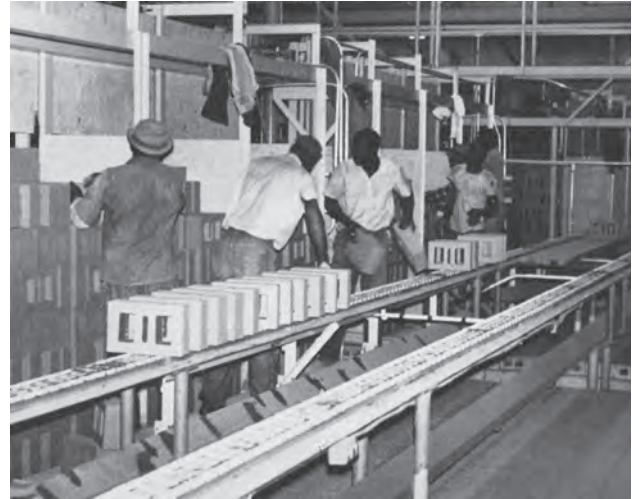
Bild 11.57. Handsetzstelle mit Rohlingszuführung über eine Transportplattenkette, um 1960
