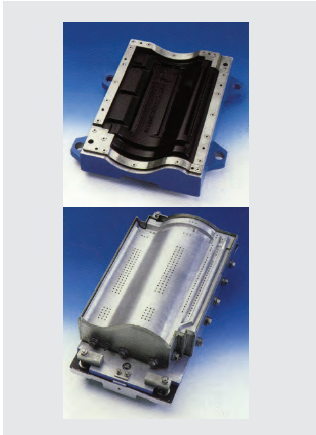
Bild 8.124b. Oben: Arbeitsform für die Verpressung mit Gummifolie oder Membrane, Unten: Saugkopf zur Abnahme der Formlinge, Rieter/Konstanz
