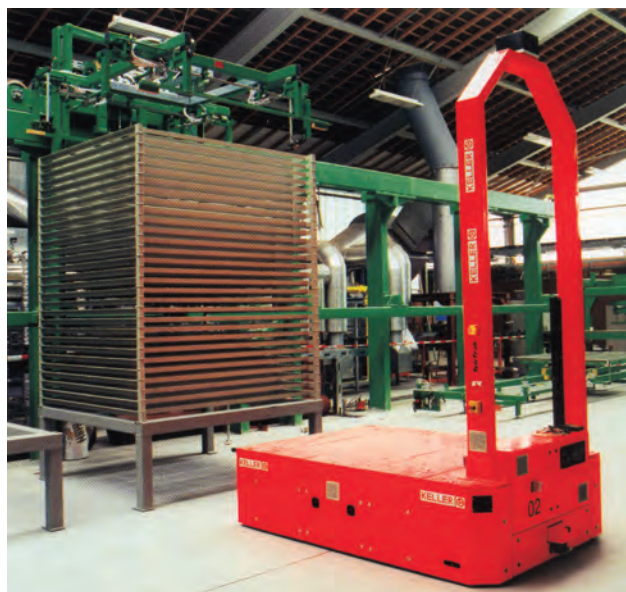
Bild 11.70. Lasergesteuertes fahrerloses Transportsystem für Speicherboxen, 1998
