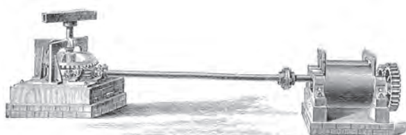
Bild 12.3. Über Pferdegöpel betriebenes Walzwerk
