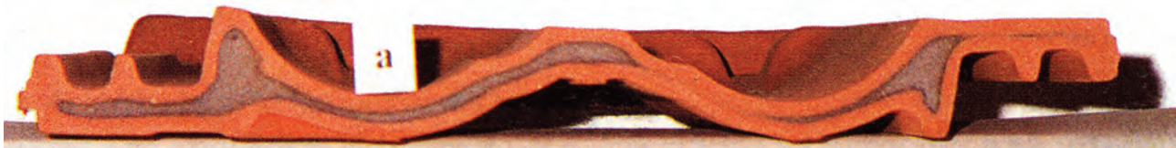
Bild 10.7. Oben: Reduktionskern im Außensteg eines Hochlochziegels, unten: Dachziegel mit durchgehendem Reduktionskern
