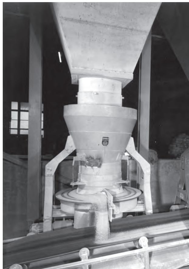
Bild 7.78. Tellerdosierapparat mit Aufsatz zur Dosierung von Zuschlagstoffen
