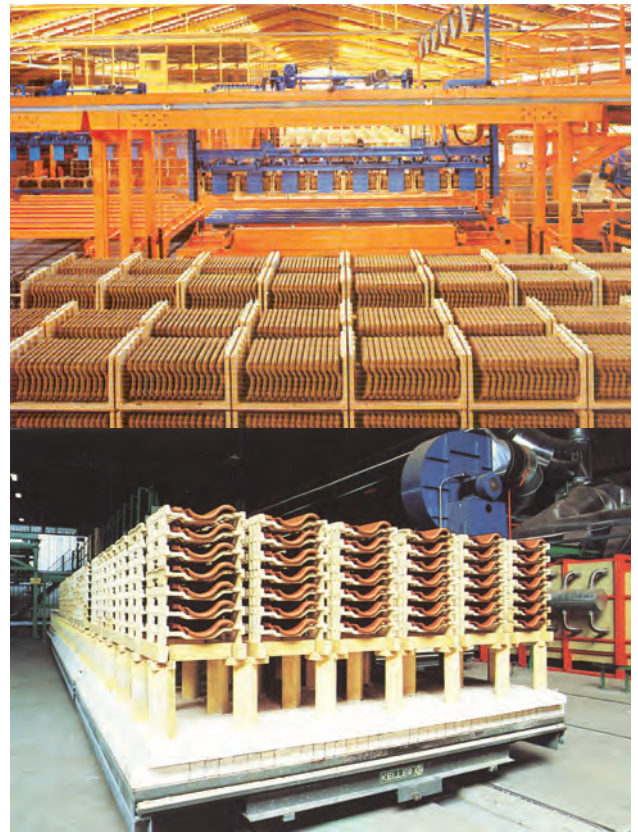
Bild 10.28. Tunnelofenwagenbesatz mit Dachziegeln. Oben mit U-Kassetten, unten mit H-Kassetten
