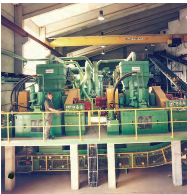
Bild 7.31. Aufbereitungsanlage mit zwei Schwingenwalzwerken zur Feinstzerkleinerung des Tons
