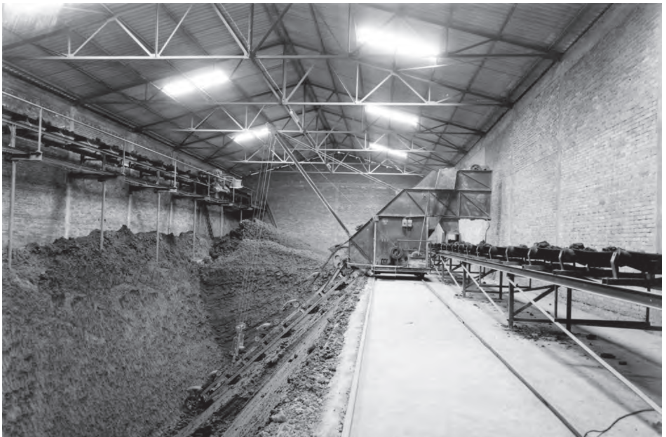
Bild 7.120. Längssumpfanlage um 1950, Eimerkettenbagger mit Seilzug
