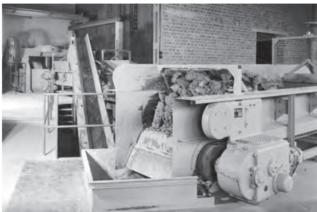
Bild 7.76. Kastenbeschicker zur Beschickung eines Kollergangs, um 1970
