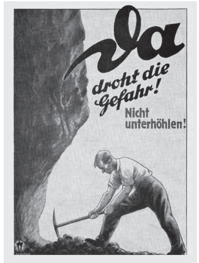
Bild 6.19. Unterhöhlen der Tonwand
