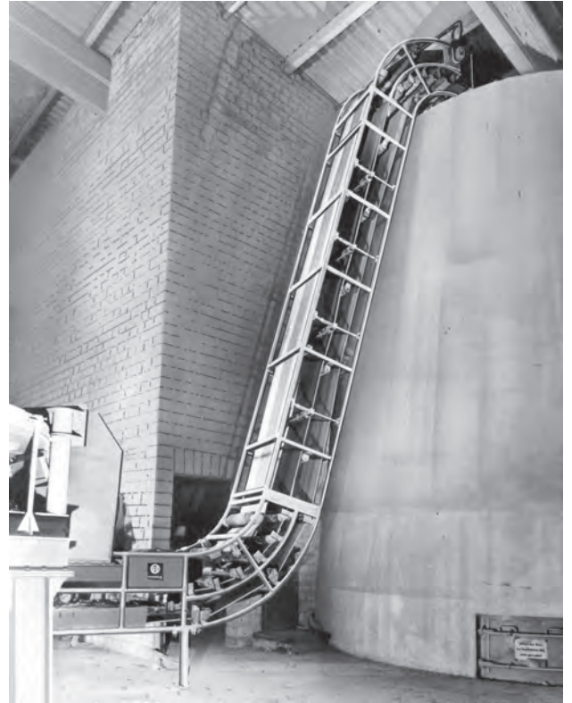
Bild 11.19. Deckband- oder Doppelgurtförderer zur Beschickung eines Tonsilos
