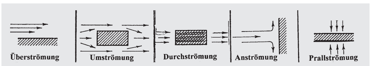
Bild 9.73. Schema der Möglichkeiten der Trockenluftführung bei der Konvektionstrocknung
