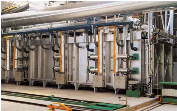
Bild 10.185b. Lingl-Herdwagenofen oder Shuttle-Ofen in Modul-Bauweise für einen Anwendungstemperaturbereich von 900 °C bis 1600 °C zum Brennen von Zubehördachziegeln, Vormauerziegel-Spezialitäten und feuerfesten Steinen
