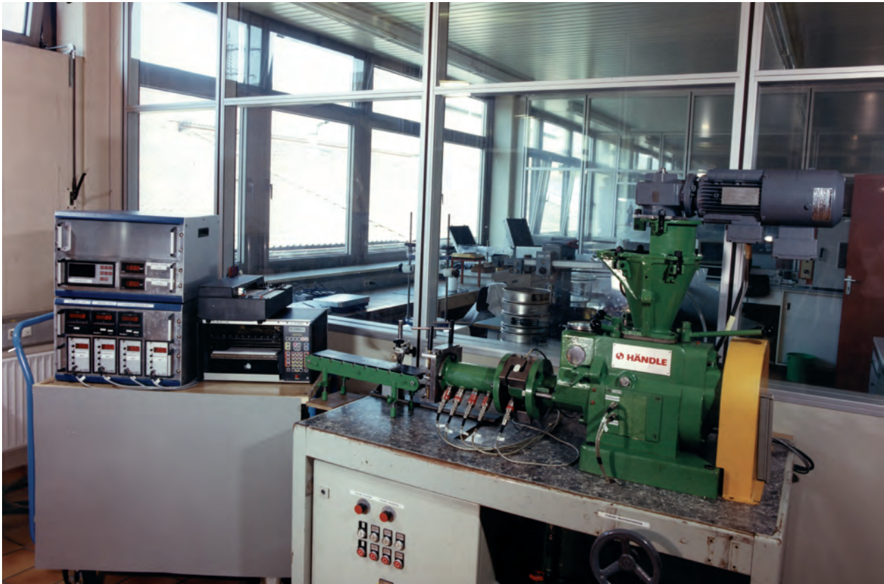
Bild 5.42a. Versuchs- und Meßanlage mit Vakuumextruder zur Ermittlung des rheologischen Verhaltens von Preßmassen und Herstellung von Prüfkörpern für den weiteren Untersuchungsgang
