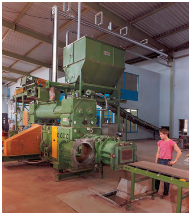
Bild 8.82b. Vakuumaggregat mit Silo und Förderschnecke zur Zugabe von Styropor zur Leichtziegelherstellung
