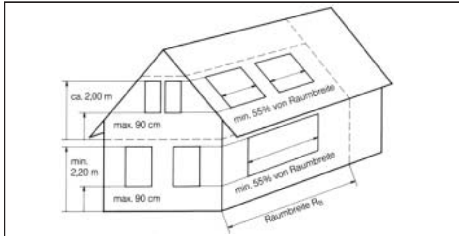
Bild 6: Fenstermaße nach DIN 5034 (für Dachgeschoß abgeleitet)
