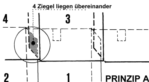
Vier-Ziegel-Eck bei der Aufschnittdeckung (Kurzschnittziegel, Hohlpfanne)
